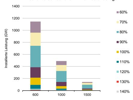
Abbildung 31 Leistungspotenzial (in GW) differenziert nach Standortgüte bei unterschiedlichen Wind-Abstandsregeln
