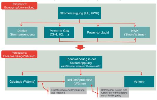
Abbildung 4 Einordnung von Sektorkopplungstechnologien
